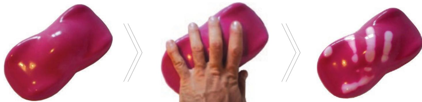
Les peintures Thermochromiques réagissent aux différents niveaux de température en changeant de couleur, en disparaissant ou en apparaissant. Elles sont disponibles en base acrylique ou solvantée, avec plusieurs couleurs et paliers de températures. La réaction de changement de couleur est progressive, immédiate et réversible.
